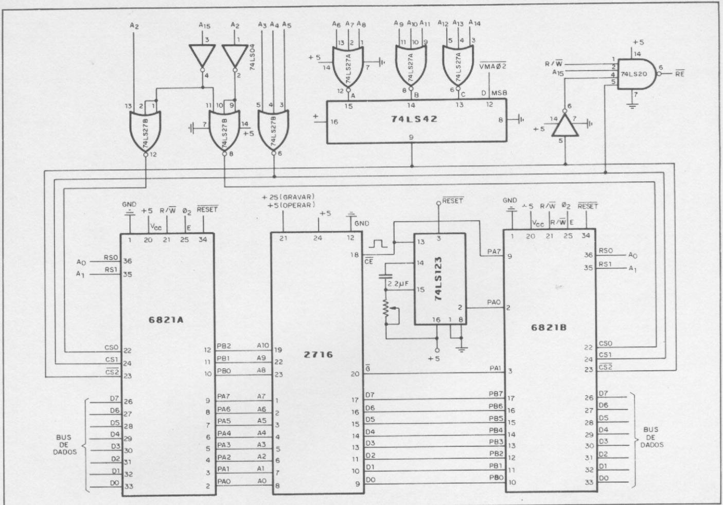
Figura 1 – O circuito de gravação/verificação.
